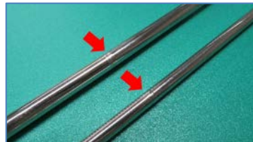
水素ステーション用高压配管溶接
