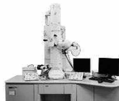
透過型電子顕微鏡システム
