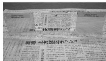
写真2 単結晶ダイヤモンドチップで切削したアルミ片
