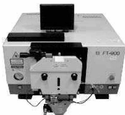
レーザー干渉平面度測定装置
