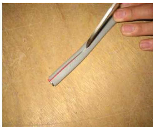
上図：ナイフで被覆を剥ぎ取る作業
