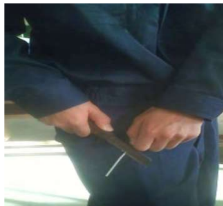
上図：ナイフで被覆を剥ぎ取る作業
