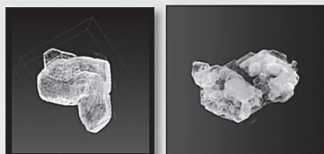
【TEMトモグラフィシステムによる 上記カオリナイトの3D(立体)画像】 取得された連続傾斜像から 3次元再構成します。
