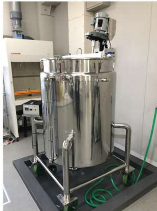
300L発酵槽 (中高温C)
