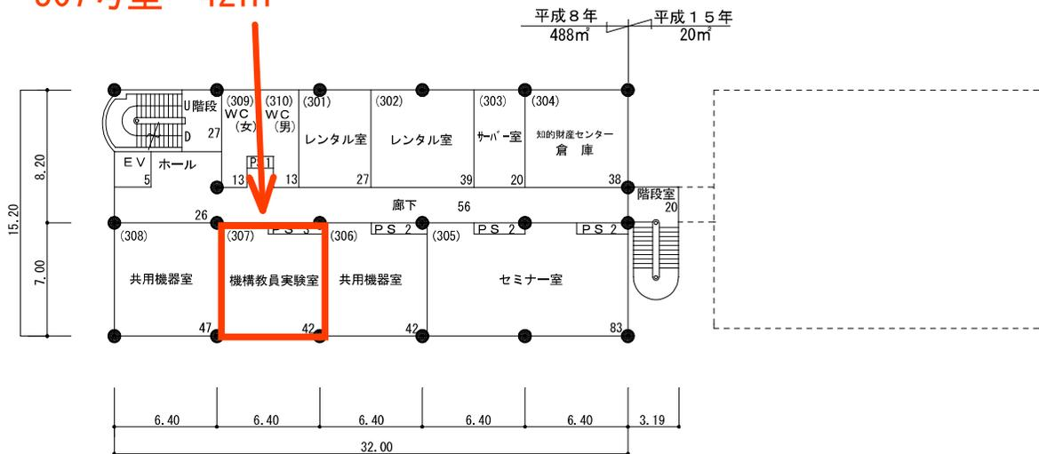
3階平面図 S=1/400 508m<sup>2</sup>
