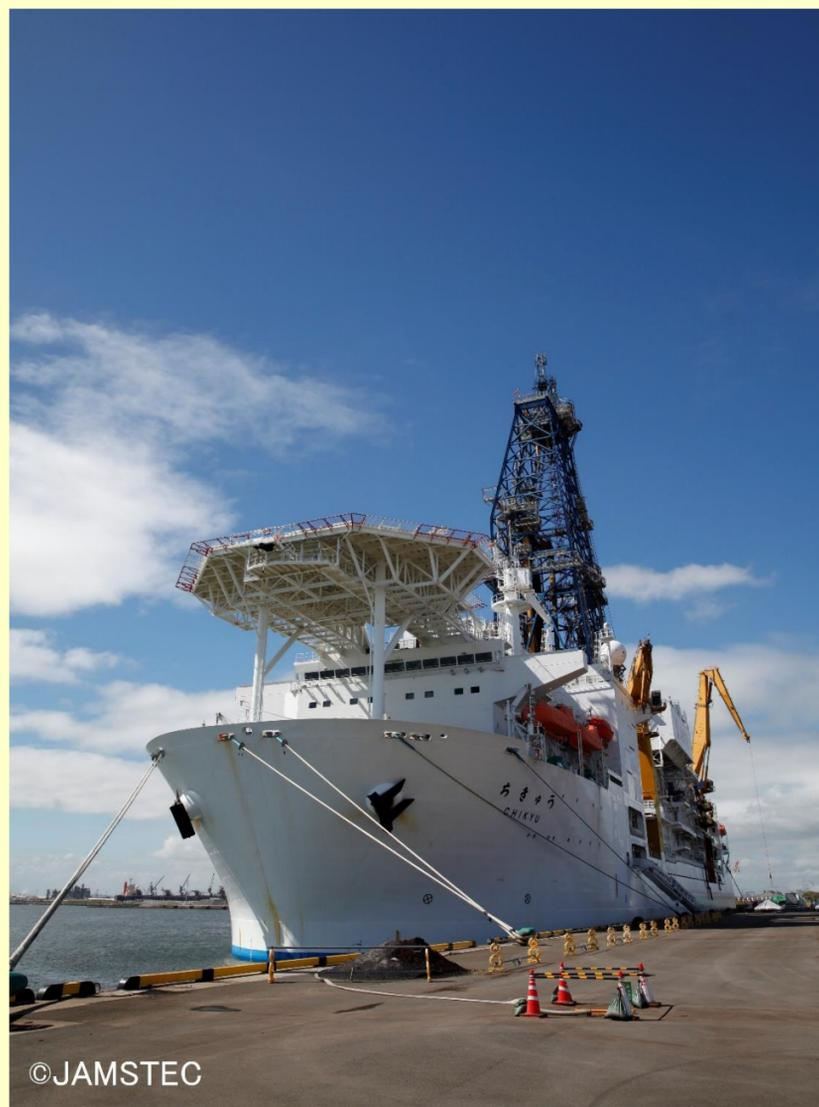
JAMSTECが所有する地球深部探査船「ちきゅう」は2005年に建造完了後、現在、運用13年目を迎えています。その仕様は総トン数5万7千トン、5万馬力の世界最大の科学掘削船です。「ちきゅう」は、水深2,500mから海底下7,000m（ドリルパイプ全長約10,000m）まで掘削する能力があり、船上から懸垂し掘削するドリルパイプの重量は8,000mの長さでは500トンにもなります。この能力を携え「ちきゅう」は、日本が世界をリードするIODP（国際深海科学掘削計画）の中心探査船として、巨大地震発生メカニズムの解明、生命の起源等について、世界約30か国の研究者が乗船し世界第一級の成果を達成しています。また、日本周辺に眠る海底資源の把握にも努めており沖縄熱水噴出域でのレアアース調査、南海トラフでのメタンハイドレート調査にも携わっております。
