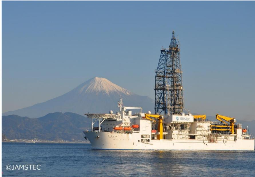
JAMSTECが所有する地球深部探査船「ちきゅう」は 2005 年に建造を終え、現在、運用11 年を迎えております。その仕様は、総トン数 5万7千トン、5万馬力の世界最大の科学掘削船です。
